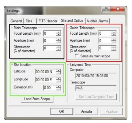
Nella sezione bordata di nero (nella figura) inserire i dati del vostro telescopio principale. Nella sezione rossa il telescopio di guida, se si usa lo stesso telescopio principale anche come guida (per esempio se avete una CCD con il doppio sensore o se usate una guida fuori asse) spuntare la voce <Same as main scope>
